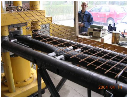
a) Birleştirilmiş Lastik Çekme testi
