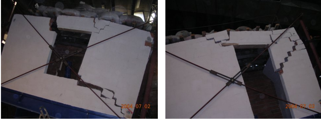
a) Ana duvarlar üzerinde oluşan çapraz çatlakların dağılımı
