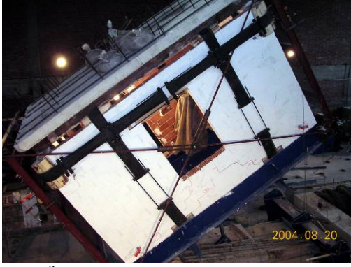
a) 34° derecede oluşan çatlaklar
